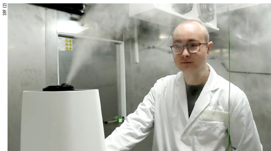
Vernebler: Prüfler misst in Ipi-Klimakammer die Befeuchtungsleistung
